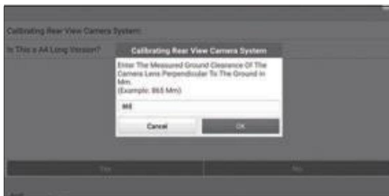
10. リアビューカメラシステムの調整が開始されます。キャリブレーションが正常に完了するまで、画面上の指示に従ってください。
